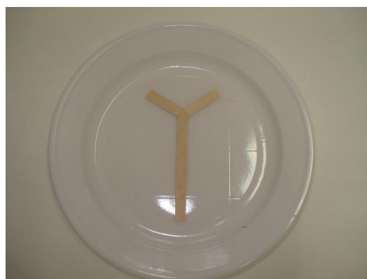
Molde 2 – Molde para chip de gelatina com um canal em forma de Y.
