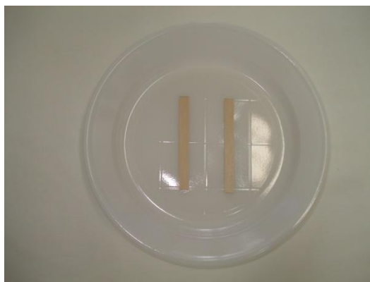
Molde 3 – Molde para chip de gelatina com dois canais paralelos.
