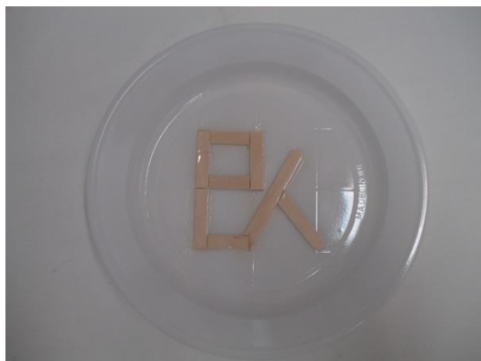
Molde 1 – Molde para chip de gelatina com um canal que descreve as letras “OLÁ”.
